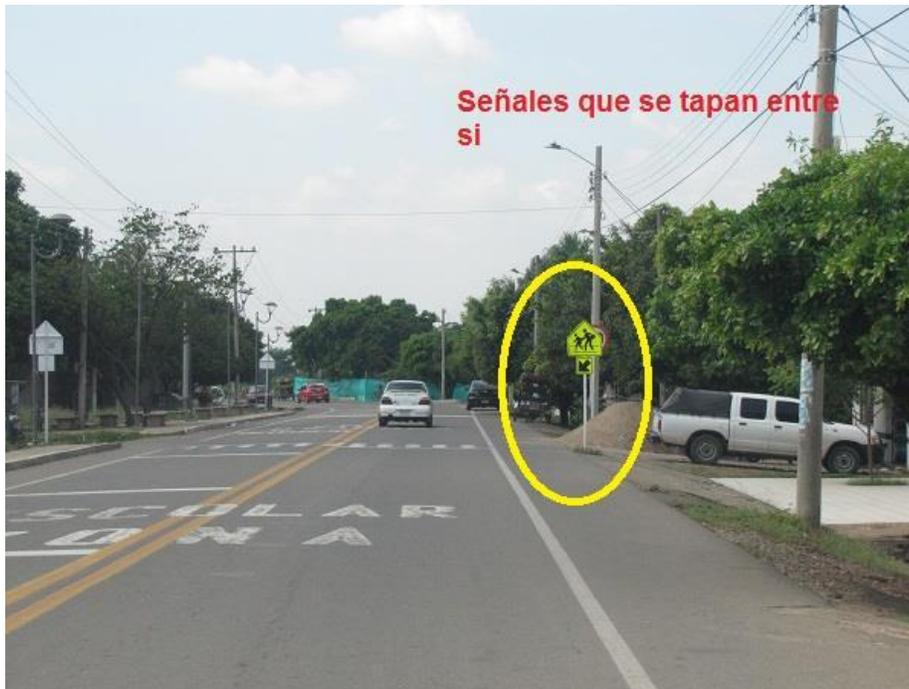
Registro fotográfico 46- Señales verticales que tapan otra señalización y zona de tráfico calmado sin todos los elementos – Municipio de San Diego. Fuente: Elaboración Propia.
